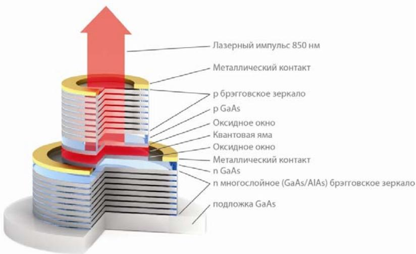
К числу основных преимуществ VCSEL по сравнению с традиционными лазерами относятся малая угловая расходимость и симметричная диаграмма направленности выходного оптического излучения, температурная и радиационная стабильность, групповая технология изготовления и возможность тестирования приборов непосредственно на пластине. Планарная технология ВИЛ позволяет формировать интегрированные линейные массивы и двумерные матрицы с большим числом индивидуально адресуемых излучателей.
