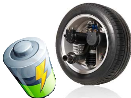
Электромотор, встроенный в колесо Audi e-tron
