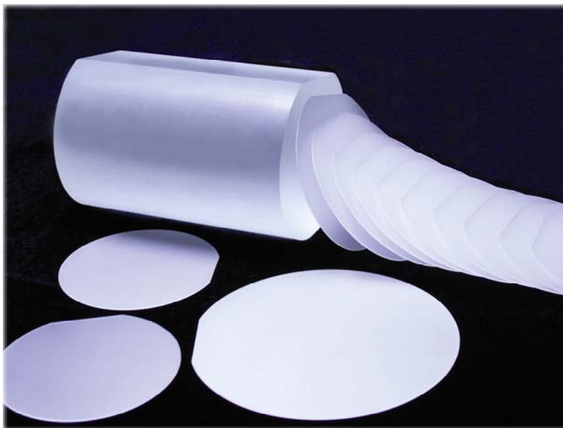
Сапфировый цилиндр и пластины после резки
