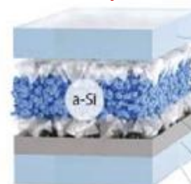
Структура аморфного модуля
