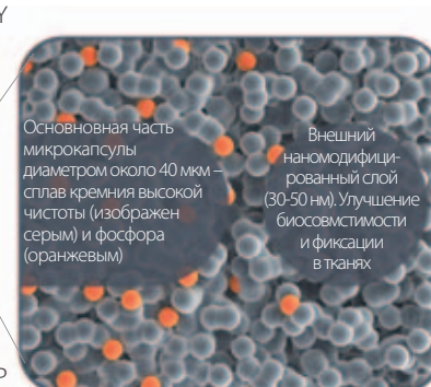
Кремниевые микросферы (40 мкм) с использованием изотопа ^{32}\text{P}
