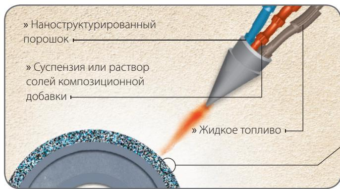
Покрытие наносится на детали и узлы установок, подвергающиеся максимальной нагрузке
