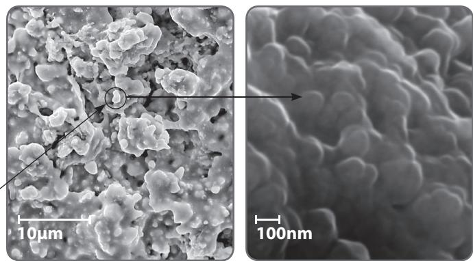
Состав: карбид вольфрама, оксид титана, оксид алюминия, хром, молибден
